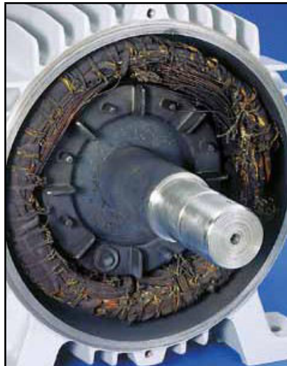
Figura 2.17 – Motor queimado devido sobrecarga ou rotor travado.
