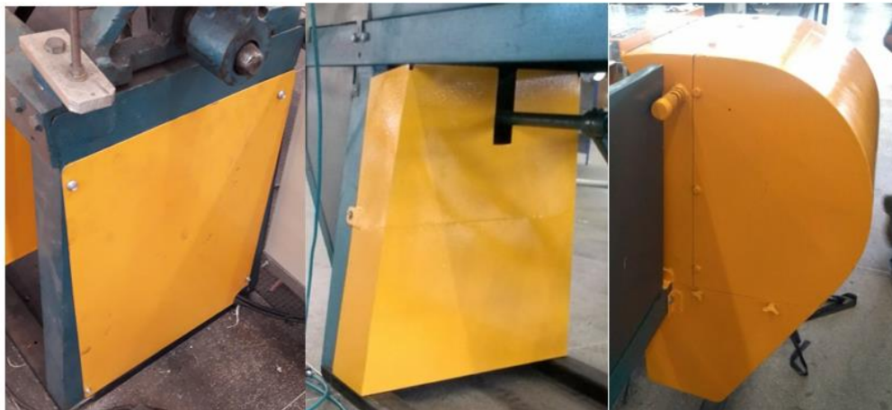
Figura 8: Eixos de transmissão protegidos
