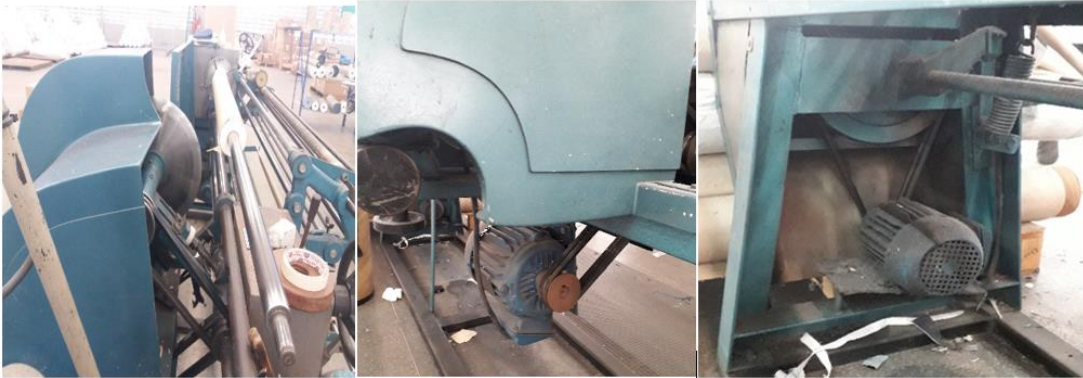
Figura 4: Eixos de transmissão expostos
